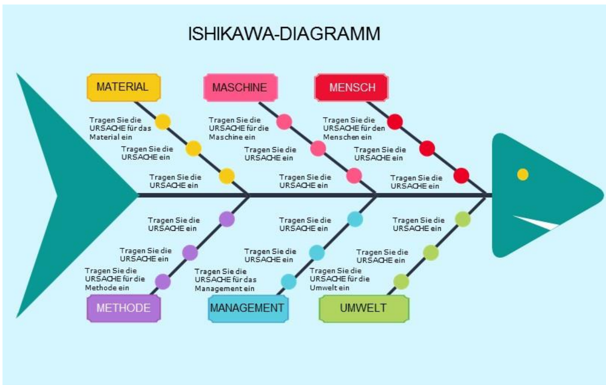
Abbildung 11. Das Ishikawa-Diagramm - Ursache-Wirkungs-Diagramm adaptiert nach Górný.
